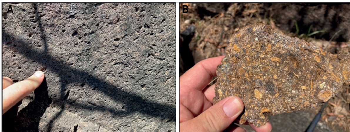
Figura 85. Muestra PC222 (425502 E/ 1099241V) A) Ignimbrita color gris rosado con textura eutéxica, las vesículas de desgasificación se encuentran orientadas. B) Brecha piroclástica, medianamente soldada, meteorizados color amarillo, cuya matriz contiene óxidos de hierro.
