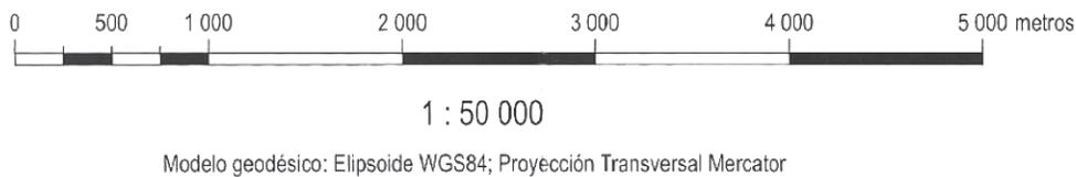
**Figura 2.** Ejemplo de escala y referencia a la proyección cartográfica
