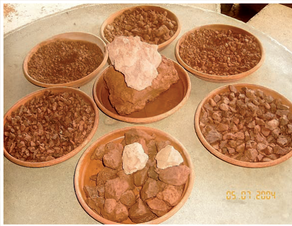
Diferentes tamaños obtenidos por trituración de roca volcánica.
